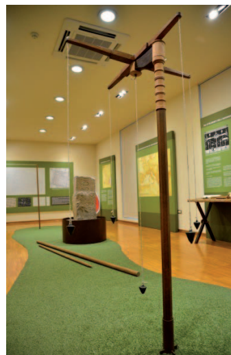
Groma di epoca romana, Museo della Centuriazione romana, Borgoricco. Per gentile concessione del Museo.
